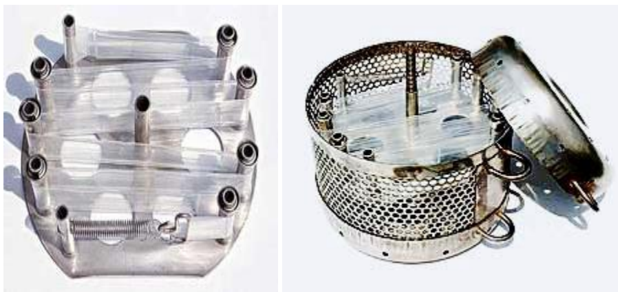
Figur 1: Spindel med påmontert membran til venstre, og bur med spindel og membran til høyre.
