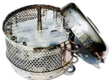
POCIS-holder, stålbur og spindel for SPMD. Stålburet kan brukes for både POCIS og SPMD.
